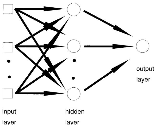
Fig. 2. A multiple layer perceptron.
